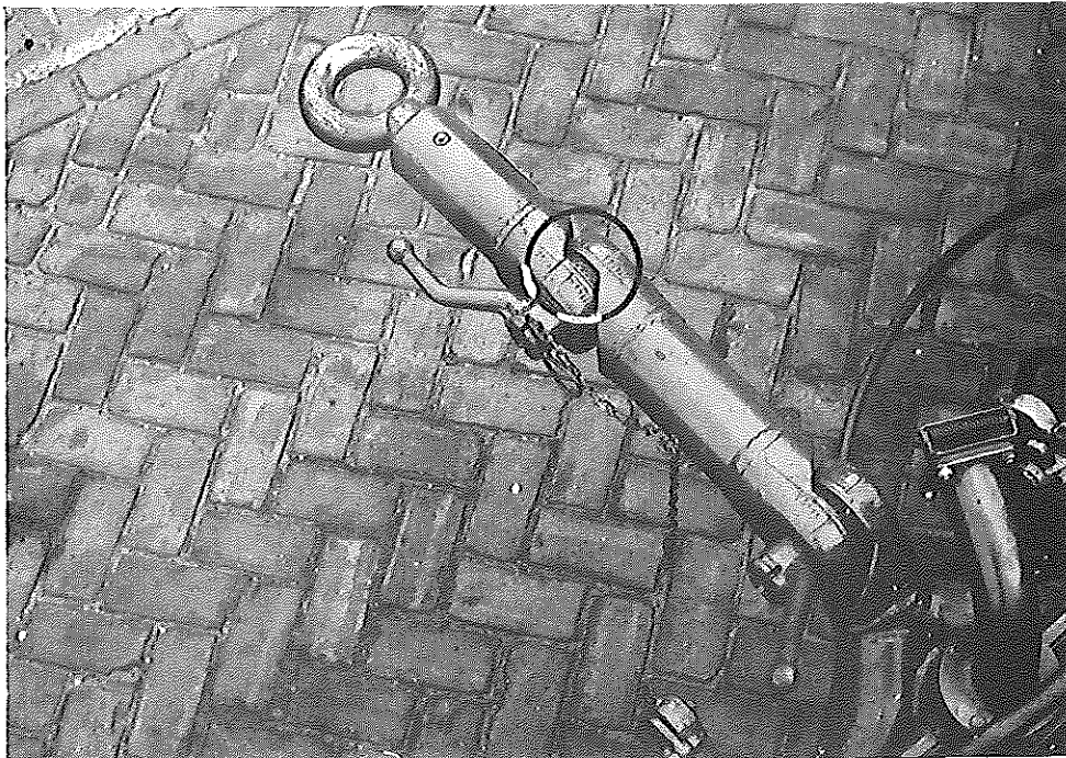
AFB. 8. TREKBOOM MET MERKSTREPEN VOOR VERSTELLING
